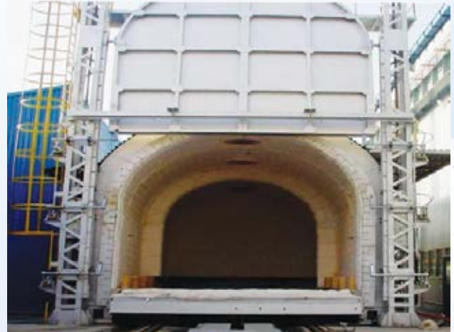
FURNACE ( P.W.H.T & S.R )
